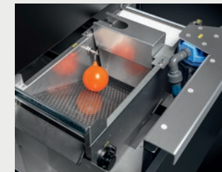
Automatische Abfalltrennung im Späneförderer
